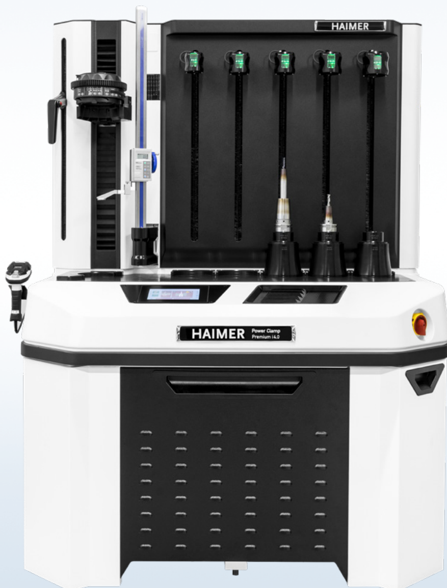
사진은 길이 설정 보조장치와 스캐너(옵션사항들)이 포함된 PC407-I22-C11-EU 제품입니다 Picture shows PC407-I22-C11-EU with length presetting and scanner (optional)
