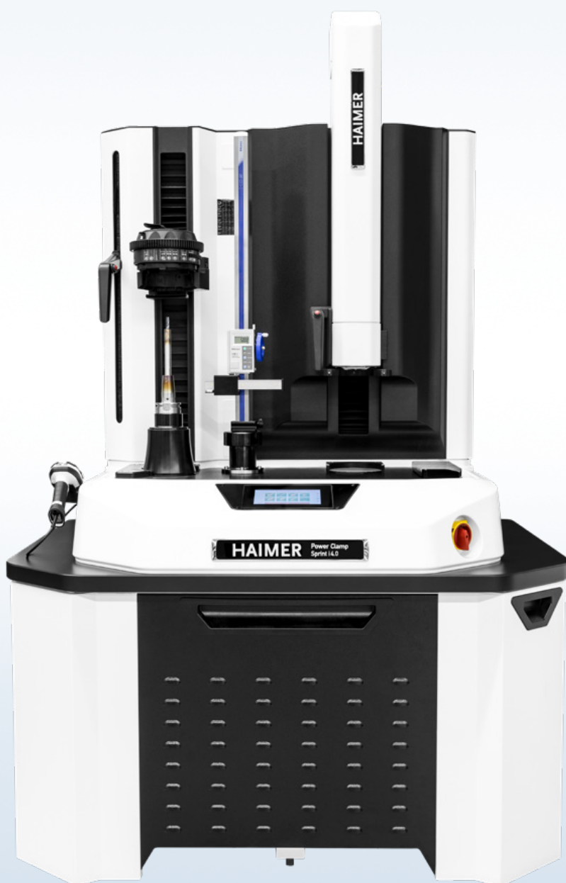
사진은 공구길이 설정 보조장치와 스캐너가 포함된 PC408-I22-C21-EU 모델입니다 Picture shows PC408-I22-C21-EU with length presetting and scanner (optional)
