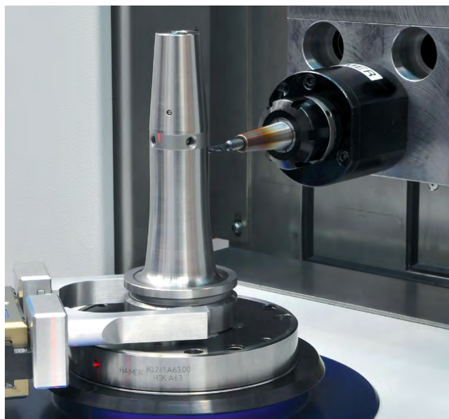
CNCユニットによりアンバランスを自動修正 Automated compensation of unbalance via CNC machining unit
