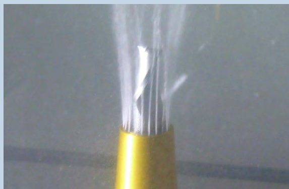
ノズル付きスリーブ—遠心力により刃先までクーラントが届かない Slip-on sleeve with nozzles – ineffective cooling, coolant does not reach the cutting edges
