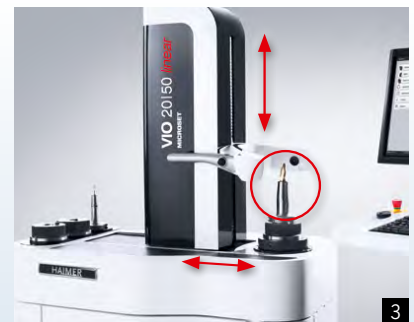
1: 旋削バイト芯高調整用第2カメラ(オプション)/Second camera for measuring the centre of rotation (optional) 2 + 3: 最新のリニアドライブによる全自動駆動/Fully automatic axis drive via modern linear technology
