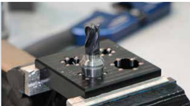
Pinza Duo-Lock con cabeza de fresado Duo-Lock y dispositivo de sujeción/ Pinça Duo-Lock com cabeça de fresagem Duo-Lock e dispositivo de aperto
