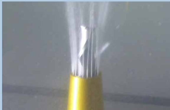
Système de douilles – refroidissement inefficace, fluide lubrifiant n'accède pas les arrêtes de coupe Riduzione con ugelli – raffreddamento inefficiente, il liquido refrigerante non giunge fino al tagliente
