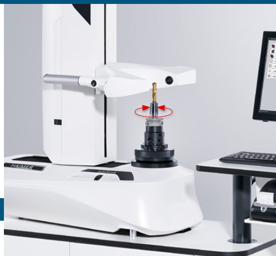
Mise au point automatique par dent Messa a fuoco automatica del tagliente
